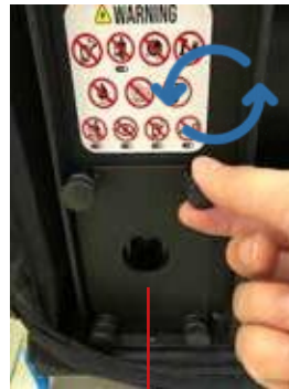
Tiroir de batterie
